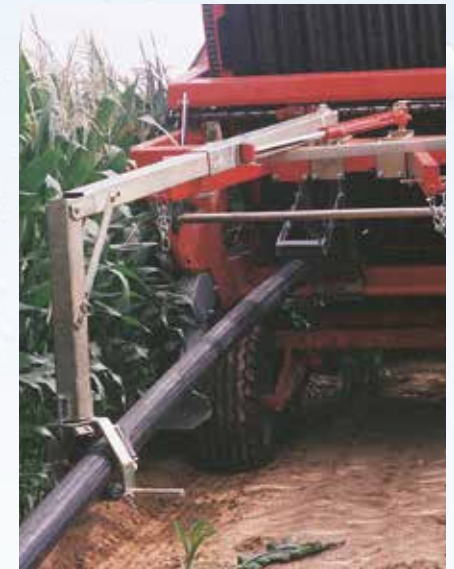
Arm om de slang achteraan af te rollen (optioneel voor de modellen 790 Gx, 890 Gx, 990 Gx, 1100 Gx), standaard op 1200 Gx.
