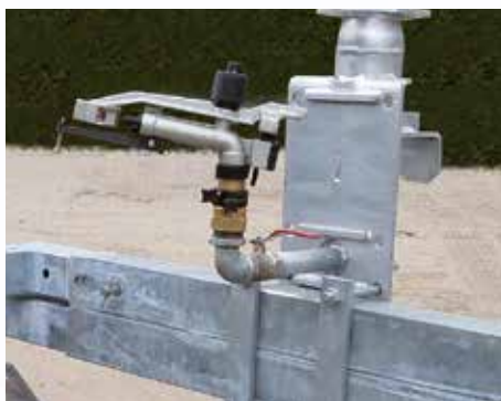
Extra sproeier K1 in een scherpe hoek op de wagen gemonteerd.
