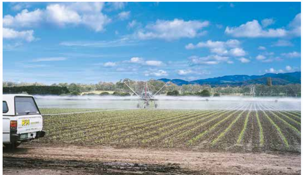
Sproeierleiding Albatros van 72 meter met structuur (optioneel voor het model 990 Gx en 1100 Gx).
