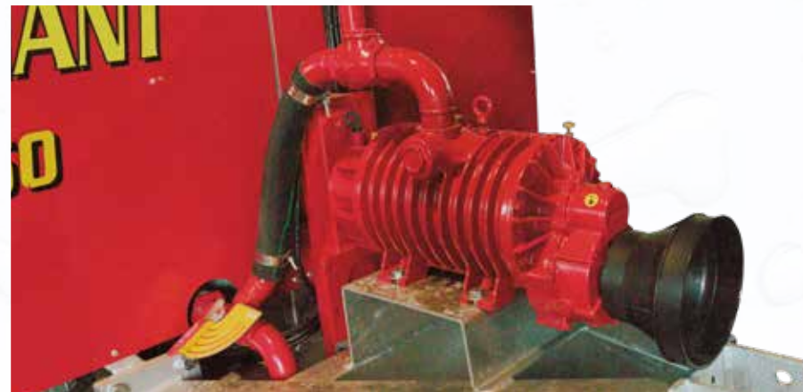
Compressor voor het leegmaken van de buis JUROP 9000 lt.
