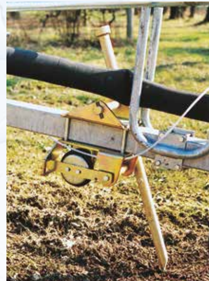
Inrichting om de wagen met houweel aan de grond te vergrendelen (voor modellen waarbij de slang achteraan wordt afgerold).
