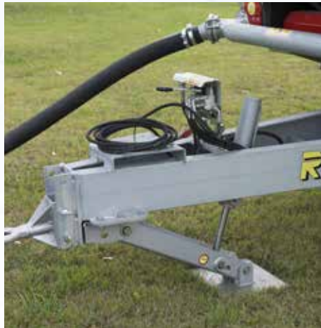
Hydraulisch kantelbare roervoet (optioneel voor 790, 890, 990 en 1100 GX).
