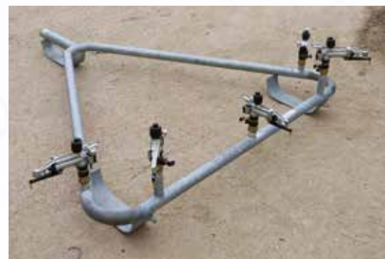
Apparaat voor irrigatie onder het gebladerte van boom- en wijngaarden als vervanging van de standaardwagen.
