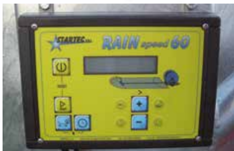
Digitale meter-teller Rain Speed 60 om de snelheid van het oprollen te meten.
