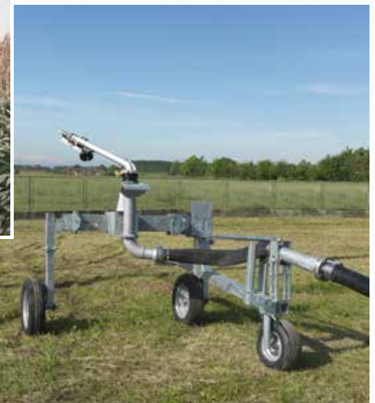
Arm om de slang achteraan af te rollen (optioneel voor de modellen 790 Gx, 890 Gx, 990 Gx, 1100 Gx), standaard op 1200 Gx.
