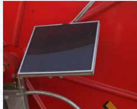
Zonnepaneel voor de voeding van de elektronische apparaten.
