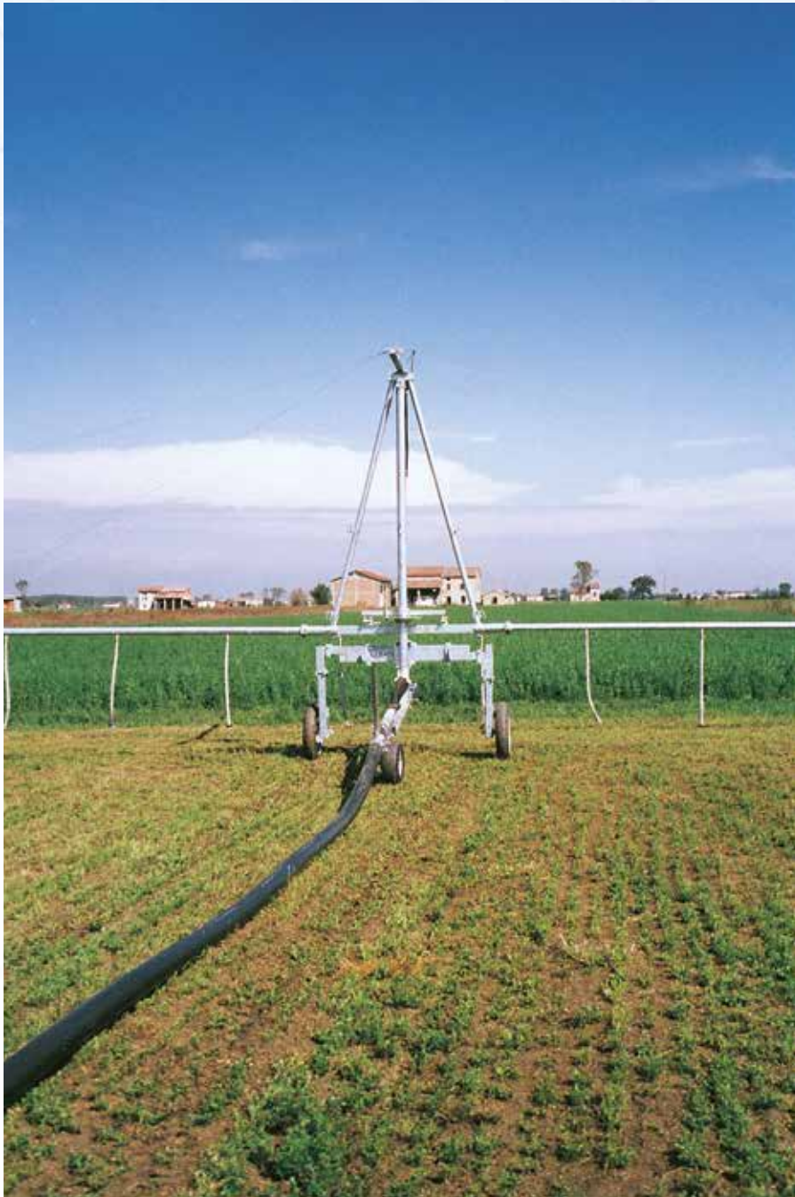
Sproeierleiding van 28 meter in staal voor verdeling van vloeibare mest.
