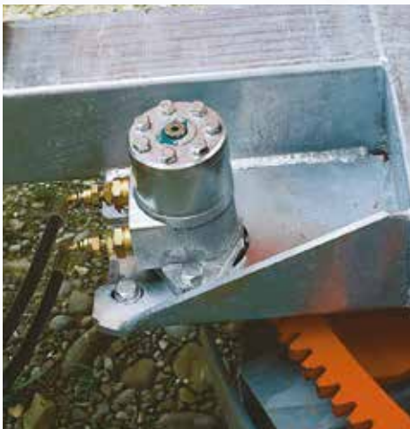
Hydraulische rotatie van de draaikrans (standaard op de modellen 990 Gx, 1100 Gx, optioneel voor alle andere modellen)
