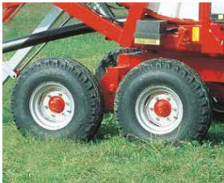
Dubbele as op asymmetrische zwengel (optioneel voor de mod. 690 Gx, 790 Gx, 890 Gx, 890 Gx Evo).
