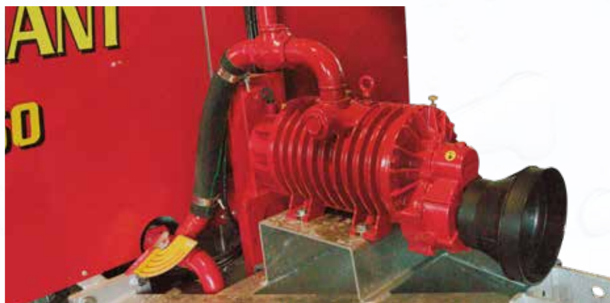
Compresor para el vaciado del tubo JUROP 9000 lt.
