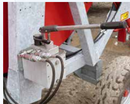
Bomba manual para el accionamiento de los soportes posteriores de anclaje y elevación del carro (opcional en los modelos 570 Gx Evo, 581 Gx Evo, 690 Gx, 790 Gx).
