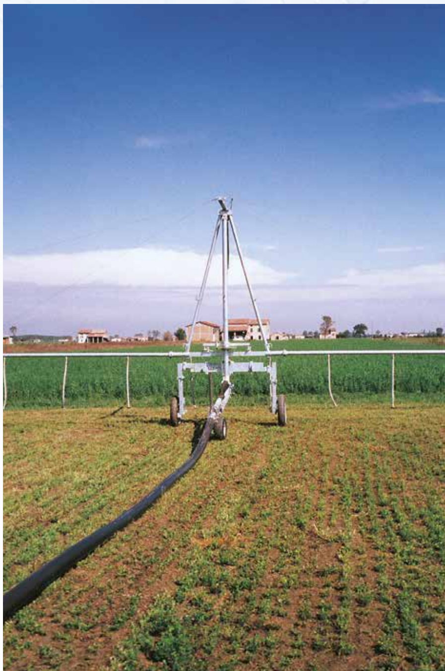
Barra de acero para la distribución de purín, de 28 metros con tubos de salida al terreno
