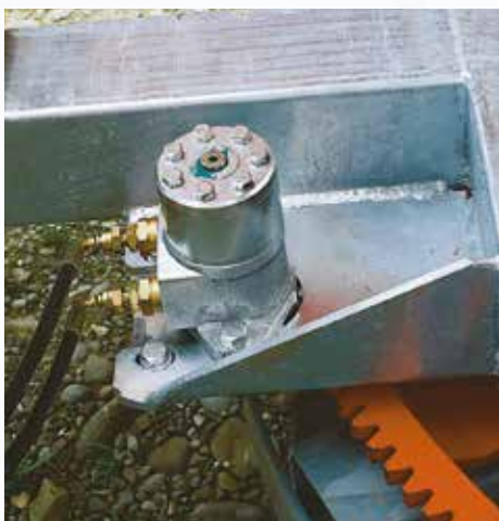
Rotación hidráulica del sistema de acoplamiento (de serie en los modelos 990 Gx, 1100 Gx, opcional para todos los demás modelos).
