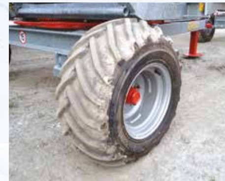
Neumático de alta flotación para el mod. 581 Gx Evo medida 26/12.00-12
