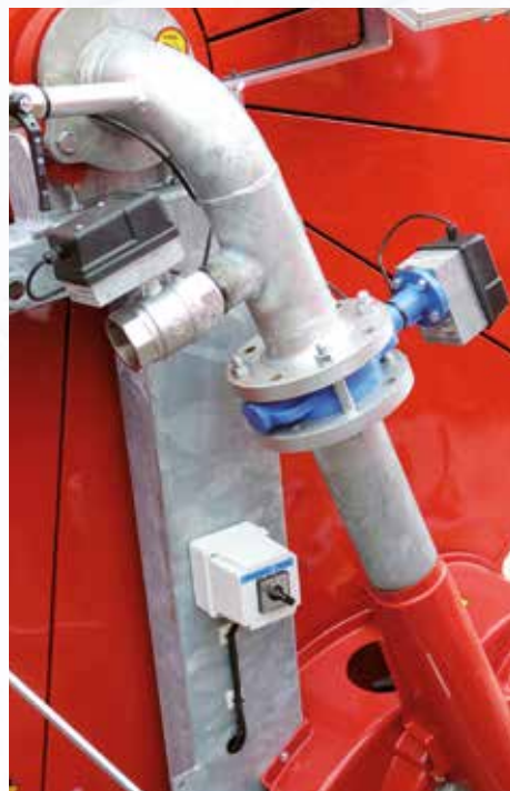
Válvula de descarga electromecánica y válvula de cierre electromecánica controladas por el programador (suministradas separadamente o asociadas y controladas mediante conmutador eléctrico).
