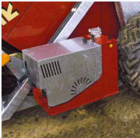
Centralita accionada mediante motor de 4 tiempos HONDA GX160 Hp 5,5 para servicios oleodinámicos.
