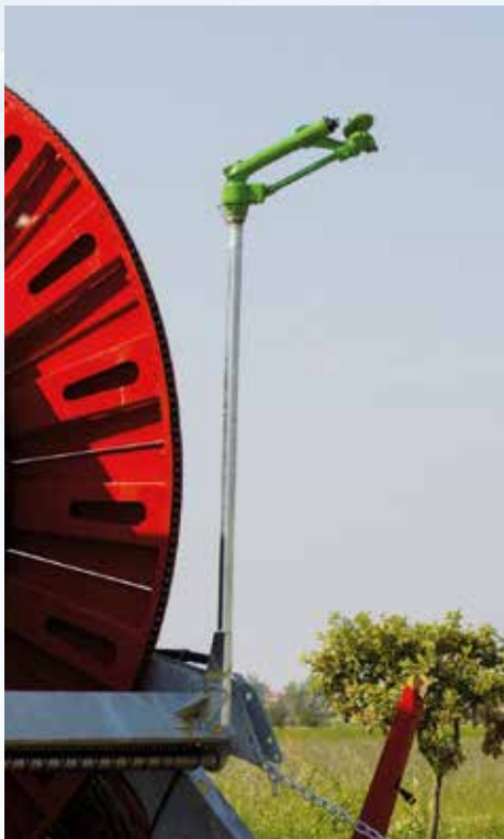
Aspersor adicional de tope controlado por el programador (mod. Skipper o KI).
