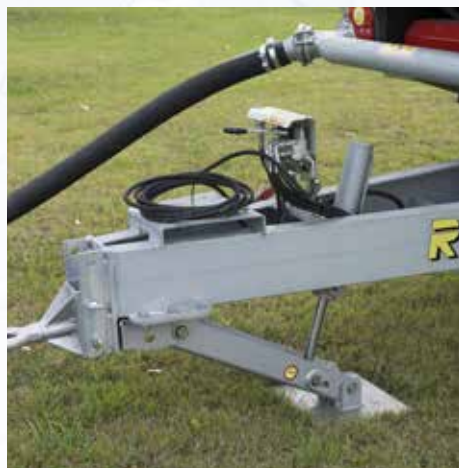
Pie timón hidráulico basculante (opcional para 790, 890, 990 y 1100 GX.)
