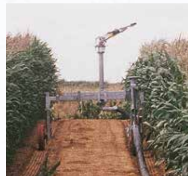
Dispositivo de bloqueo del carro al terreno con piqueta (para los modelos con desenrollado posterior del tubo)
