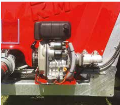
Centralita accionada mediante motor de 4 tiempos HONDA GX160 Hp 5,5 para servicios oleodinámicos.
