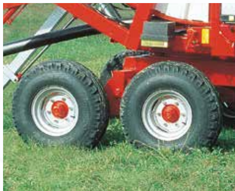
Eje doble con balancín asimétrico (opcional en los modelos 690 Gx, 790 Gx, 890 Gx, 890 Gx Evo).
