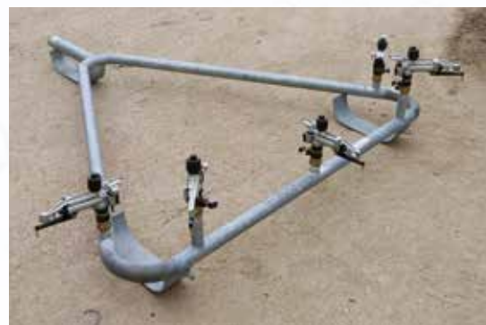
Dispositivo para el riego bajo el follaje de árboles de fruta/viñedos en sustitución del carro estándar.
