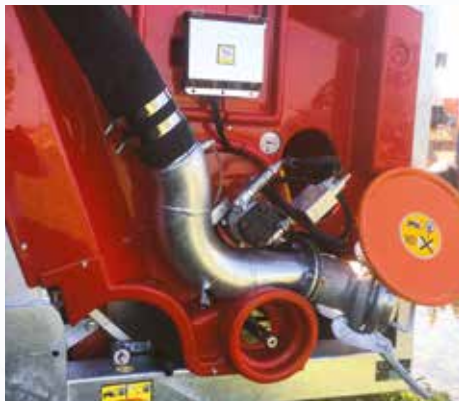
Rebobinado del tubo con motor diésel YANMAR LD70 con transmisión hidrostática, motor hidráulico en el reductor, válvula compensadora de velocidad, bomba hidráulica doble para la alimentación de los servicios, compatible con los programadores electrónicos. Esta opción sustituye el rebobinado mediante turbina.
