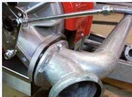
Barnizado transparente para aumentar la protección de las partes galvanizadas.
