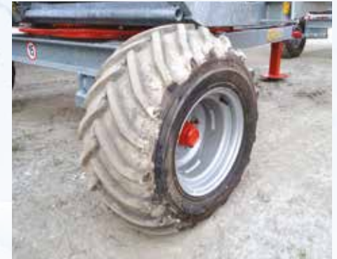
Pneumatique basse pression pour mod 581 Gx Evo mesure 26/12.00-12
