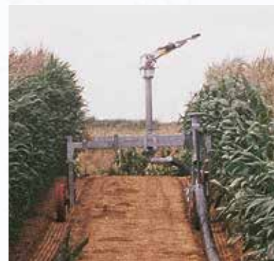
Dispositif pour blocage chariot à terre avec pic (pour les modèles avec déroulement arrière du tube)
