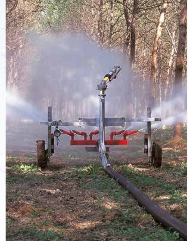
Dispositif pour irrigation sous-frondaison
