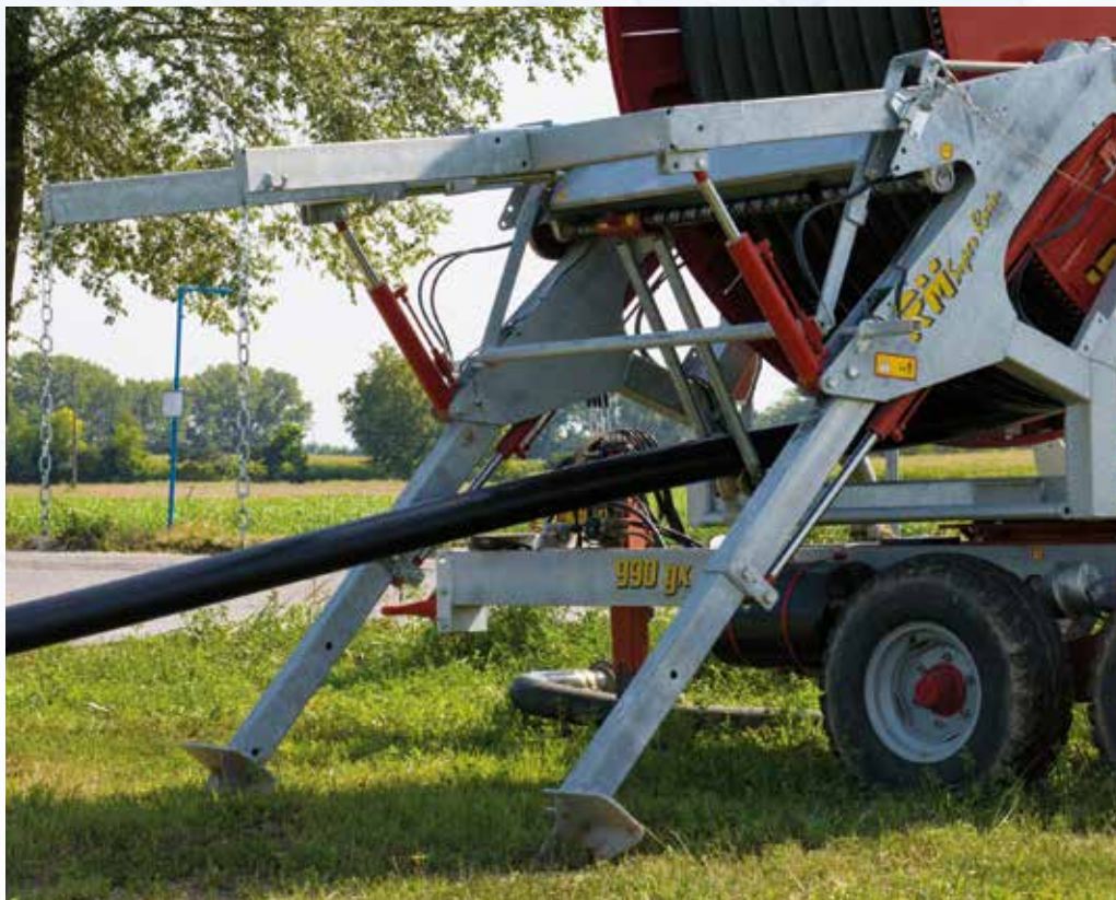
Levage de chariot indépendant commandé par un couple de vérins oléodynamiques (obligatoire avec rampe d'arrosage) pour les modèles 581 Gx, 690 Gx, 790 Gx, 890 Gx, 990 Gx et 1100 Gx.
