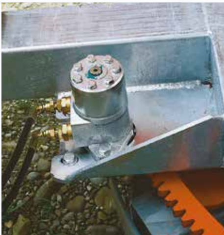
Rotation hydraulique de la tourelle (de série sur les modèles 990 Gx, 1100 Gx, optionnel pour tous les autres).
