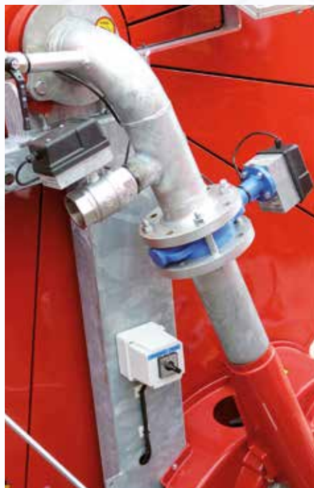
Vanne de décharge électromécanique et vanne de fermeture électromécanique commandées par un programmateur (disponibles séparées ou bien associées et commandées par un commutateur électrique).
