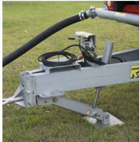
Pied timon hydraulique basculant (en option pour 790, 890, 990 et 1100 GX).
