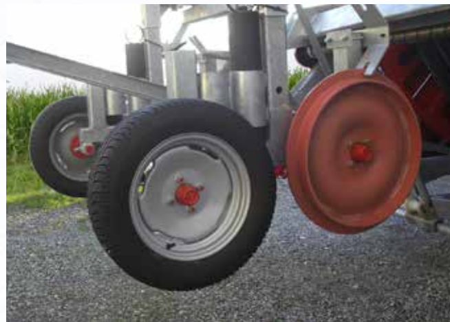
Chariot avec deux roues pneumatiques et deux roues en fonte
