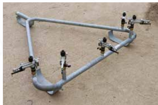
Dispositif pour irrigation sous-frondaison pour les vergers/vignobles en remplacement du chariot standard.
