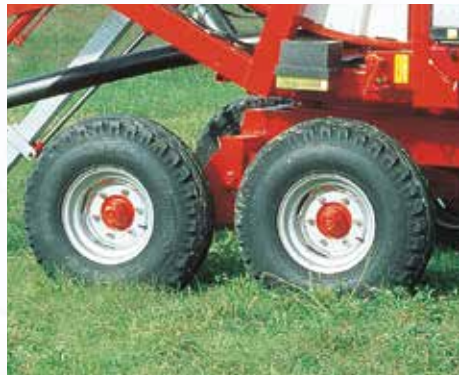
Double essieu sur bogie asymétrique (optionnel pour mod.690 Gx, 790 Gx, 890 Gx, 890 Gx Evo).
