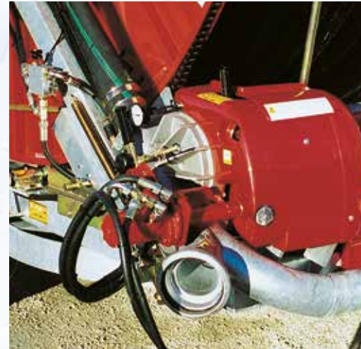
Enroulement du tuyau PE par un moteur hydraulique sur PTO, valve régulatrice de vitesse, comand d'arrêt fin enroulement et couple flexibles au tracteur
