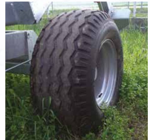
Pneumatique basse pression pour mod. 890 Gx, 990 Gx, de série sur 1100 Gx (mesure 15.0/55-17)
