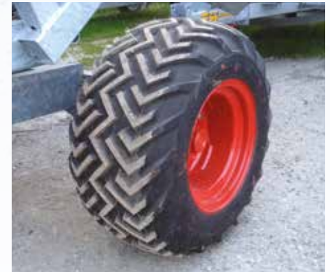
Pneumatique basse pression pour mod. 690 Gx Evo e 790 Gx mesure 31x15.50-15
