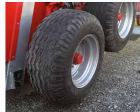
Neumáticos de alta flotación para mod. 800 jX, 840 Xj, 900 Evo eje doble, 900 Xjm, Major Evo, Major XjmEvo (medida 15.0/55-17)
