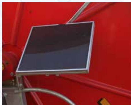
Panel solar para la alimentación de los aparatos electrónicos.
