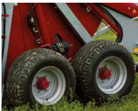
Eje doble con balancín asimétrico (opcional para el mod. 800 Xj, 840 Xj, 900 Evo, 800 Xjm).
