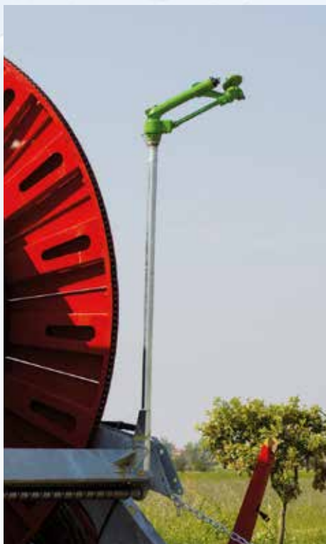
Aspersor adicional de tope controlado por el programador (mod. Skipper o K1).
