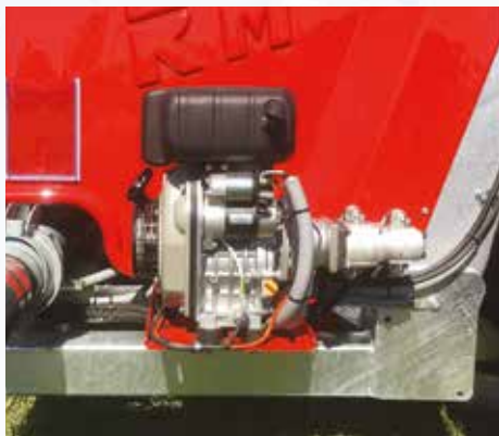
Centralita accionada mediante motor de 4 tiempos HONDA GX160 para servicios oleodinámicos.
