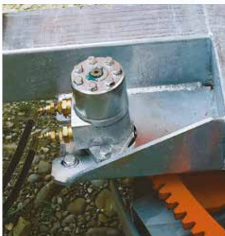
Rotación hidráulica del sistema de acoplamiento (de serie en todos los modelos, con excepción de los modelos 600 Xj, 700 Xj, 600 Xjm).
