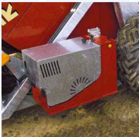
Centralita accionada mediante motor de 4 tiempos HONDA GX160 para servicios oleodinámicos.
