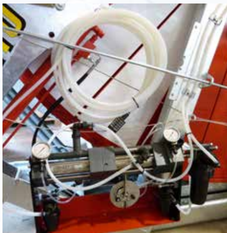
Bomba dosificadora para la fertirrigación con abono líquido
