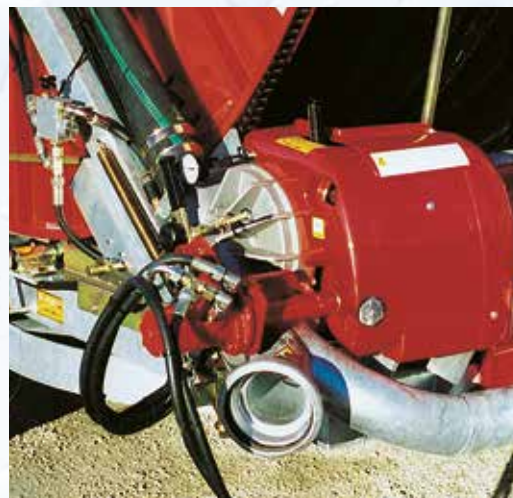
Rebobinado del tubo PE mediante motor hidráulico en PTO, válvula reguladora de velocidad, distribuidor de tope y par de conexiones rápidas al tractor.
