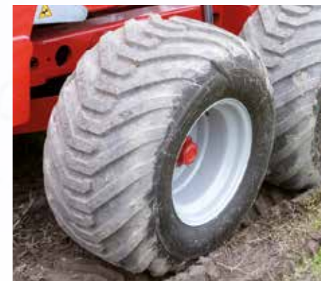
Neumáticos de alta flotación para mod. GIANT Xj, GIANT Xjm, (medida 500/50-17)
