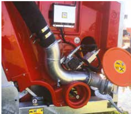
Rebobinado del tubo con motor diésel YANMAR LD70 con transmisión hidrostática, motor hidráulico en el reductor, válvula compensadora de velocidad, bomba hidráulica doble para la alimentación de los servicios, compatible con los programadores electrónicos. Esta opción sustituye el rebobinado mediante turbina (solo para mod. XJ).
