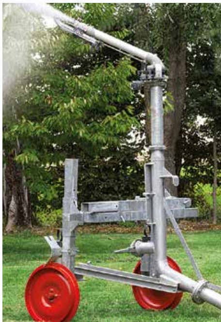
Carro con ruedas de fundición individuales (de serie en los mod. XJM) y prolongación para el riego de maíz.
