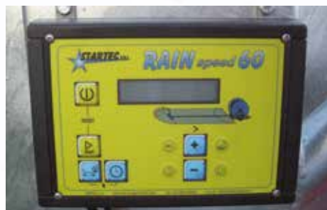
Cuenta metros digital Rain Speed 60 para la medición de la velocidad de rebobinado.
