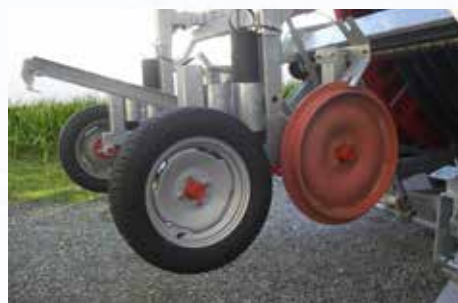
Carro de dos ruedas neumática y dos ruedas de fundición.
