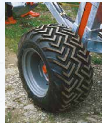
Neumáticos de alta flotación para mod. 600 Xj, 700 Xj (medida 31x15.50-15)
