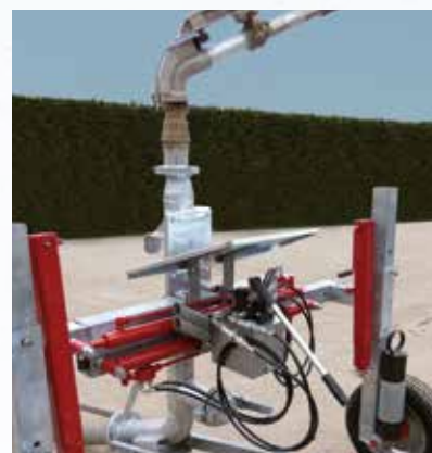
Regulación hidráulica del ancho del carro y regulación mecánica de la altura de las ruedas.
