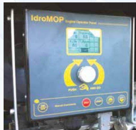
Programador IDROMOP para gestión de máquina de riego + motor diésel en los modelos XJM.
