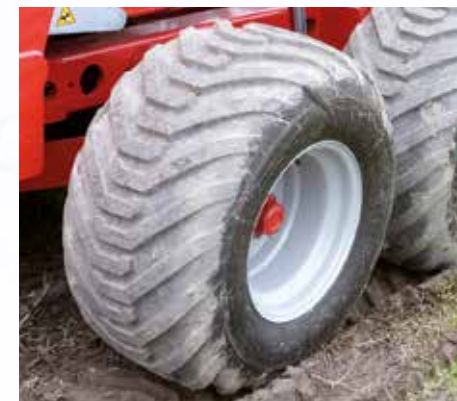
Pneumatique basse pression pour mod. Giant Xj, Giant Xjm (mesure 500/50-17)
