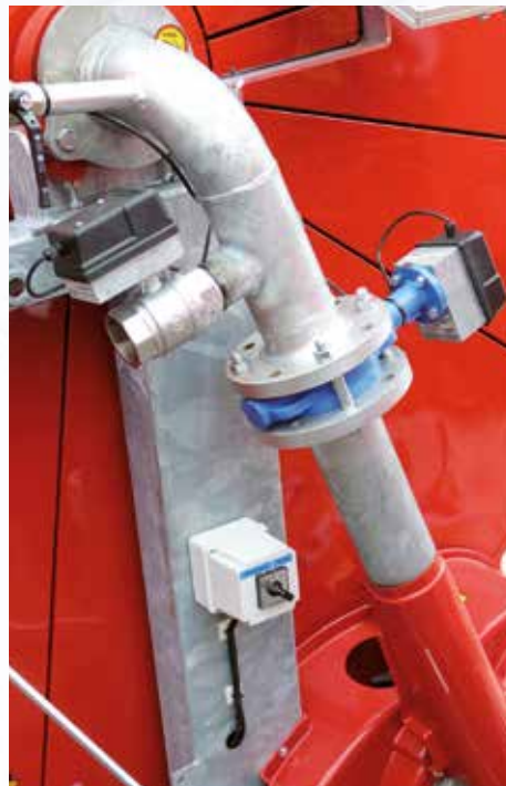
Vanne de decharge électromécanique et vanne de fermeture électromécanique commandées par un programmateur (disponibles séparées ou bien associées et commandées par un commutateur électrique).
