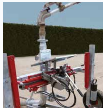
Réglage hydraulique largeur chariot et enregistrement mécanique de la hauteur des roues
