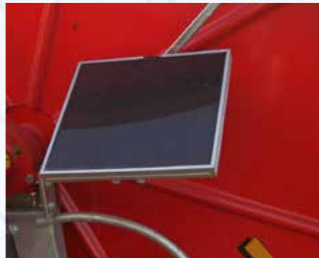
Panneau solaire pour alimentation des appareils électroniques
