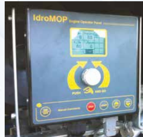
Programmateur IDROMOP pour gestion conjointe enrouleur+ moteur diesel sur modèles XJM.
