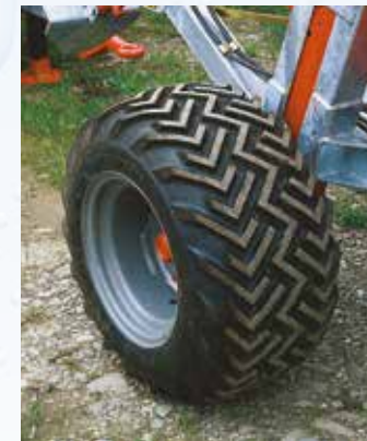
Pneumatique basse pression pour mod. 600 Xj, 700 Xj (mesure 31x15.50-15)
