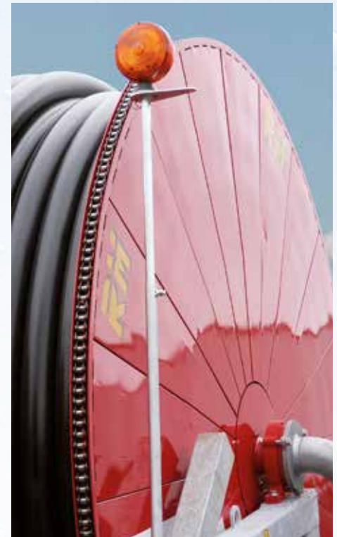
Signalisation de fin de déroulement tuyau avec lampe au xénon (pour programmateur RM).
