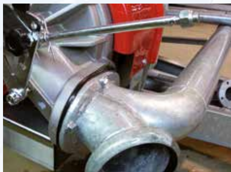
Peinture transparent pour augmenter la protection des parties galvanisées.
