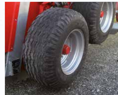
Pneumatique basse pression pour mod. 800 jX, 840 Xj, 900 Evo deux axes, 900 Xjm, Major Evo, Major Xjm Evo (mesure 15.0/55-17)
