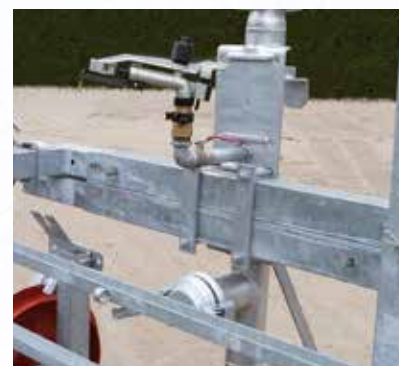
Petit canon supplémentaire K1 à angle tendu monté sur chariot
