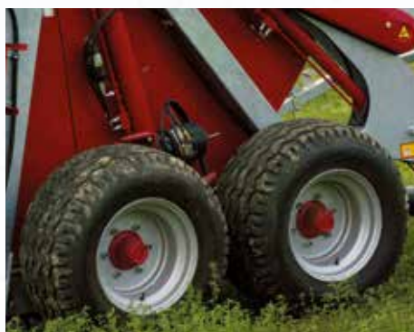
Double essieu sur bogie asymétrique (en option pour mod. 800 Xj, 840 Xj, 900 Evo, 800 XJM).
