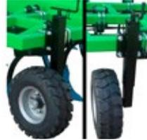
Paire de roues pneumatiques (18x7-8") avec manivelle
