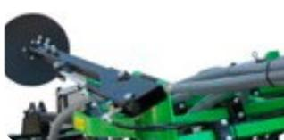
Jeu de traceurs hydrauliques (fonctionne avec 2 D.E.)
