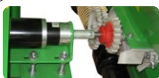
Moniteur avec entrainement du doseur par moteur électrique pour SDN (tracteur AVEC ISOBUS)
