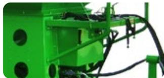
Minoration pour entrainement de la turbine directement au circuit du tracteur (seulement modèles SDN+ P -semis-)
