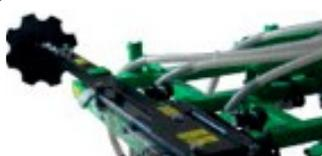
Jeu de traceurs hydrauliques (fonctionne avec 2 D.E.) (Disques crénelés)
