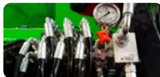
Kit de régulation de la pression de serrage du vibr. pour R75 MIX et R90 MIX
