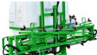
**Élévation hydraulique manuelle (verin simple effet)**
