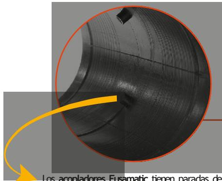
Los acopladore s Fusamatic tienen paradas de tuberías desmontables para asegurar que los tubos no se puedan insertar más allá del punto medio, pero se pueden quitar para utilizar en, por ejemplo, situaciones de reparación.
